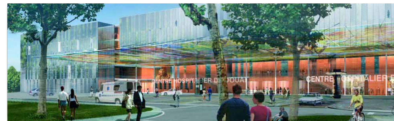
Centre hospitalier de Douai (59) Établissement conçu dans la démarche HQE®. Application du polystyrène expansé : isolation extérieure de la toiture terrasse (10400 m 2 isolés) et des patios (2800 m 2 isolés). Cabinet d'architectes : Jérôme Brunet - Éric Saunier (75003), Bureau d'Études HQE : Tribu Environnement (59)
