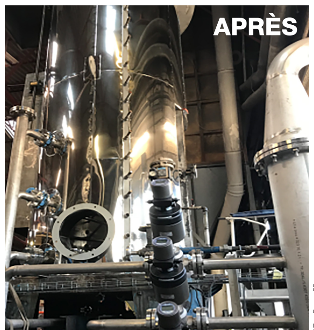
Nouvel expandeur équipé de vannes
