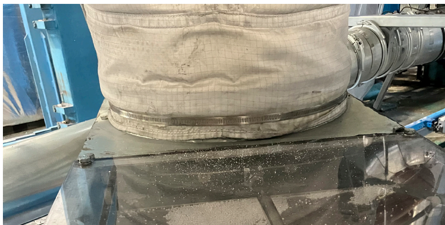
Barrière de protection en plexiglass pour éviter l'envol des billes
