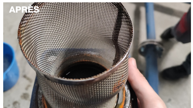
Effet du nettoyage de filtres de confinement des granulés
